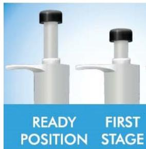
Sistema di dispensazione a doppio step, ciò determina un colpo d'ariete finale con conseguente erogazione fino all'ultima goccia di campione nel puntale; tale sistema determina un'elevatissima accuratezza e precisione.
